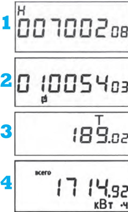
**1** При первом нажатии на кнопку, расположенную на лицевой панели, дистанционный дисплей выходит из режима ожидания и отображает заводской номер прибора учета, на который он настроен (см. рис. 1). На нашем примере № 00700208.
